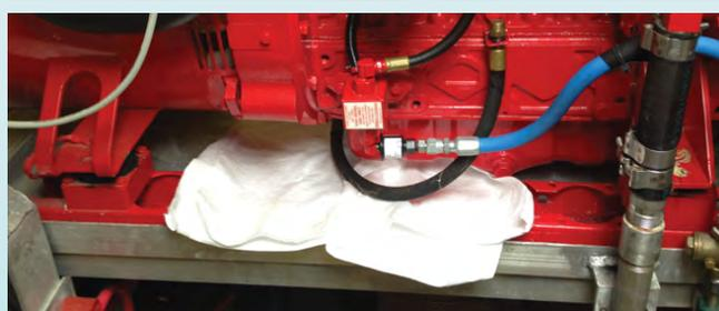
*Absorbentes para derrames de aceite (abajo), hojas absorbentes, y almohadillas que pueden conservarse en su bote para usarlos en caso de pérdidas debajo del motor o para contener y quitar aceite de la superficie del agua (arriba). Los tapetes absorbentes de derrames de aceite (arriba) atrapan el aceite derramado, y son fáciles de desechar. (MASGC/Tara Skelton)*
